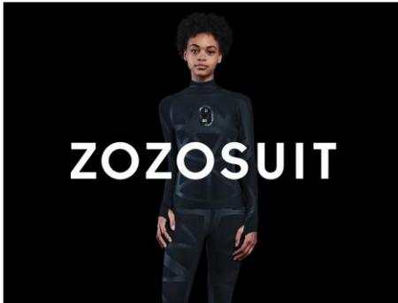
「ZOSOSUIT」は、当社がニュージーランドのソフトセンサー開発企業「StretchSense Limited.」と共同開発した、伸縮センサー内蔵の採寸用ボディースーツです。トップスとボトムスの上下を着用し、スマートフォンとBluetooth 通信で接続することで、人体のあらゆる箇所の寸法が瞬時に計測でき、そのデータを ZOZOTOWN アプリに保存する事ができます。
